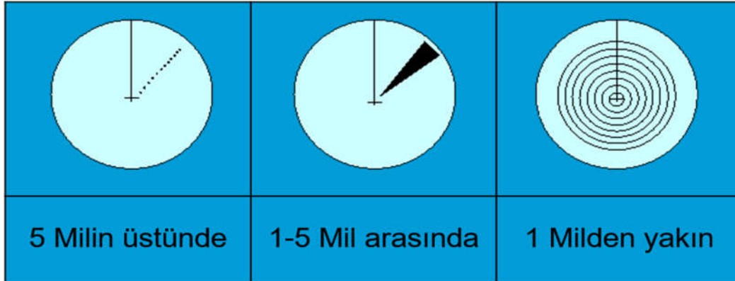
Şekil 10 SART uyarısının radarda görünüşü
